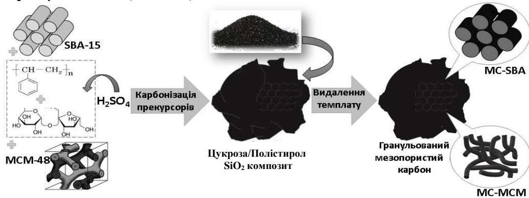
Рис. 19. Схема одержання гранульованого мезопористого вугілля.
