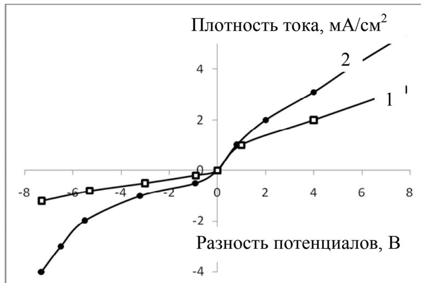
Рисунок 4.8 – Вольтамперные кривые, полученные для медной пластинки, помещенной в дистиллированную воду (1) и 0,001н раствор  $\text{CuCl}_2$  (2)
